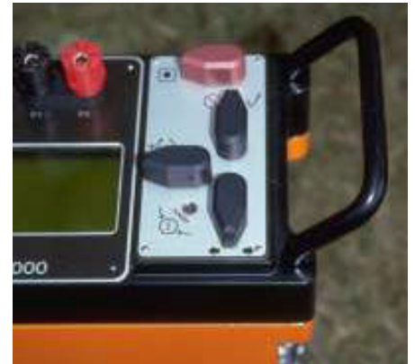
スイッチやターミナル部分 (完全防水構造である)
