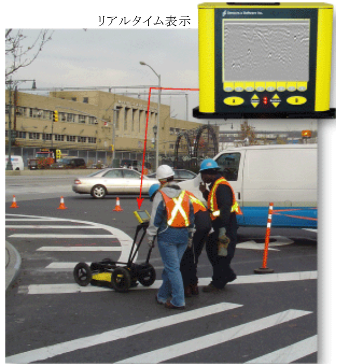
NOGGIN Plusスマートカート・コンフィグレーションによる空洞調査 (寸法:117 x 57 x 94 cm, 重量:13.3 kg)
