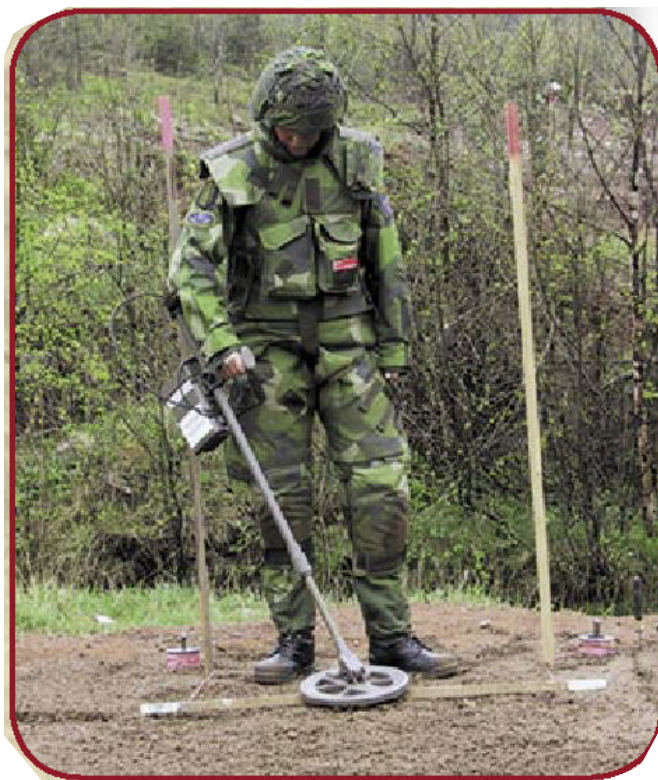
アフガンの対人地雷探査で活躍するMIL-D1モデル
